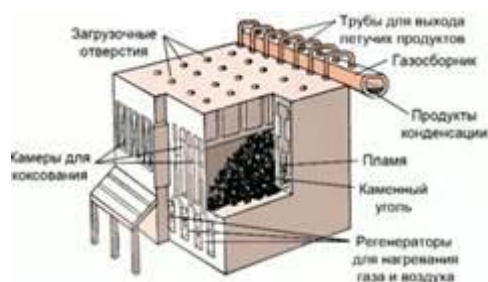
Рис. 3. Устройство коксовой печи
